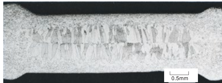
■写真5.シーム溶接部の断面組織
