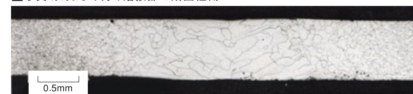
■写真4. TIGなめ付け溶接部の断面組織
