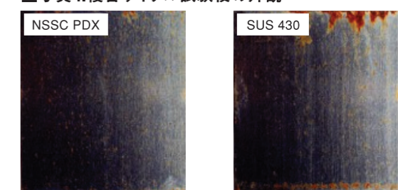
■写真4.複合サイクル試験後の外観
