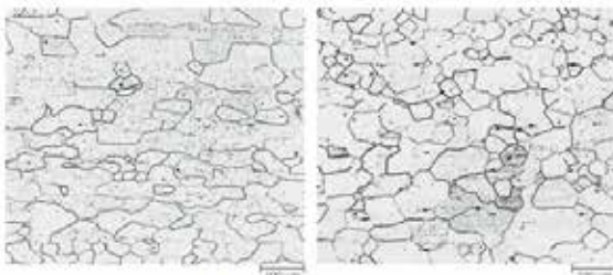
熱延焼鈍板(板厚: 3.0mm, No.1仕上げ)
