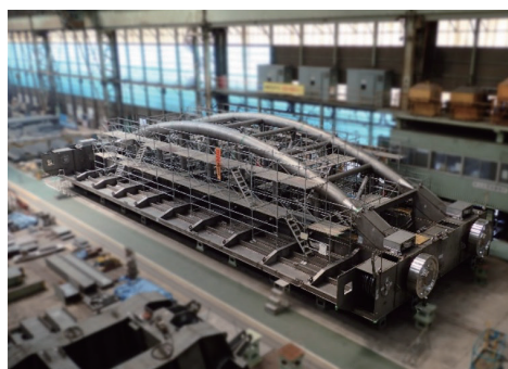
写真2.上平井水門の扉体(高11.1m×幅30m)
