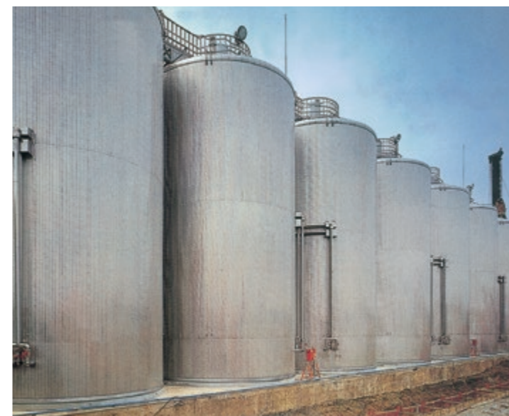
ビールタンク (SUS304高級研磨) ※外壁はSUS304薄板、内部のタンクに高級研磨品を適用。
