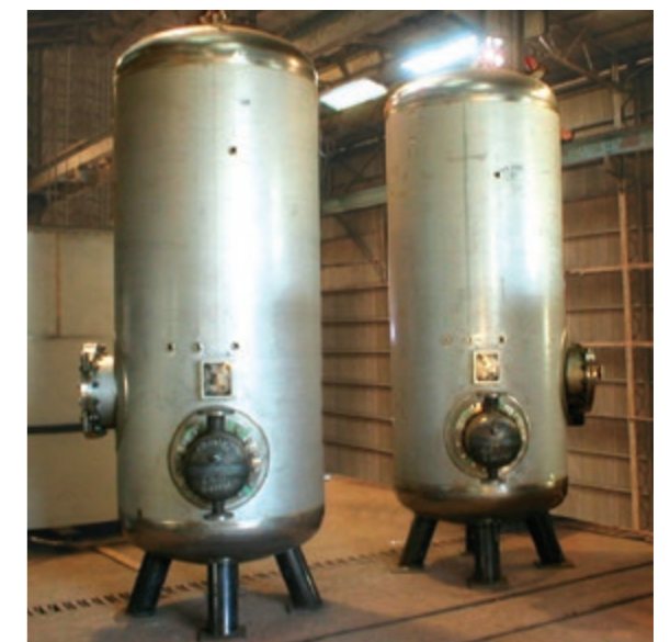
貯湯槽 (SUS444, NSSC190L)
