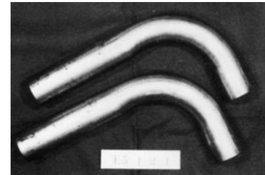
■写真5.溶接管曲げ試験外観写真(2D曲げ可)
