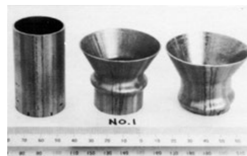
■写真3.拡管試験外観写真
